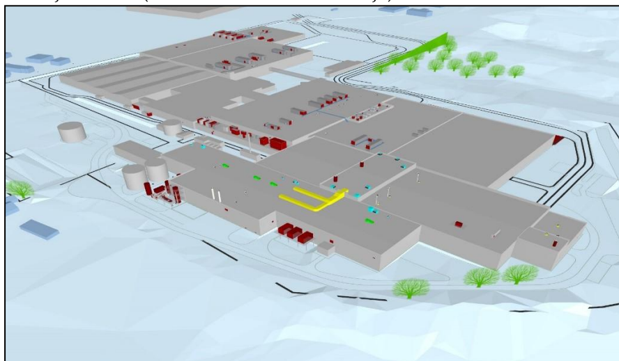
Zajmodell felépítése az IMMI zajtérképező szoftverben (háromdimenziós)
